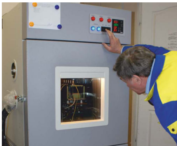
Sensor testing in a «heat-cold» chamber
